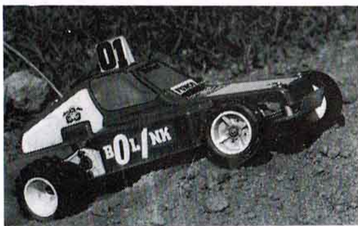
Ny El.buggy fra Bolink skala 1/10. 05 motor, vanntett radioboks, diff. og fjæring fram og bak.
